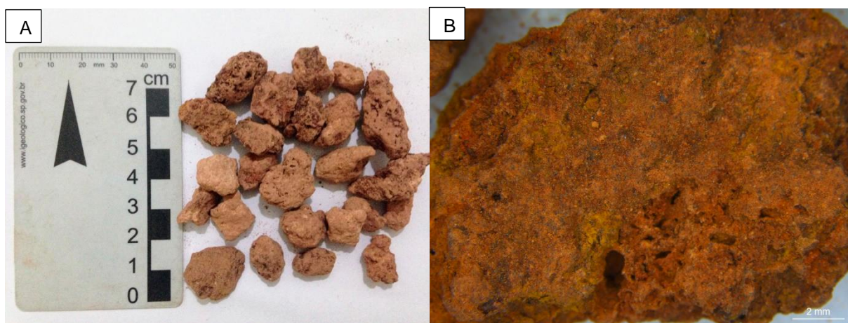
Figura 13 – Amostra de mão de bauxita do lote L2. Fragmentos predominantemente angulosos, alongados, de coloração marrom avermelhada, com regiões mais claras tendendo ao bege róseo (A); detalhe de um fragmento poroso com alterações de cor amarelada (B) (Fonte: própria).
